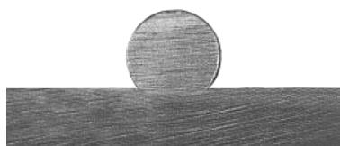
Electrosoldadura por fusión
