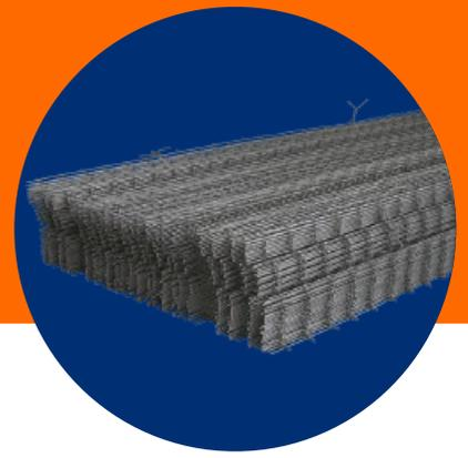
Los castillos son estructuras electrosoldadas que se fabrican con varillas longitudinales corrugadas grado 60 y por estribos lisos grado 50, todos laminados en frío.
