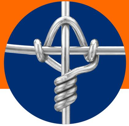
Malla hecha con alambres galvanizados con mayor resistencia y durabilidad que cualquier otro cerco perimetral, con entorches en nudo triple y tensión independiente en cada alambre horizontal.
